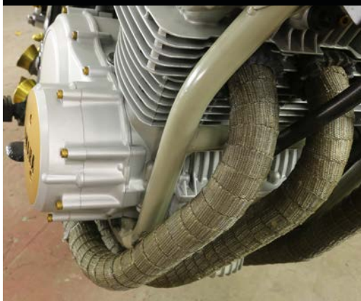
Výfuková soustava je kompletně ruční práce. Do omotaných ocelových svodů jsou umně vloženy tlumivky. Zvuk je i tak úžasný.
