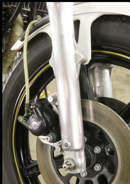
Autentičnost především: brzdová soustava prošla pouze důkladnou očistou, repasí a výměnou hadic společně s destičkami.
