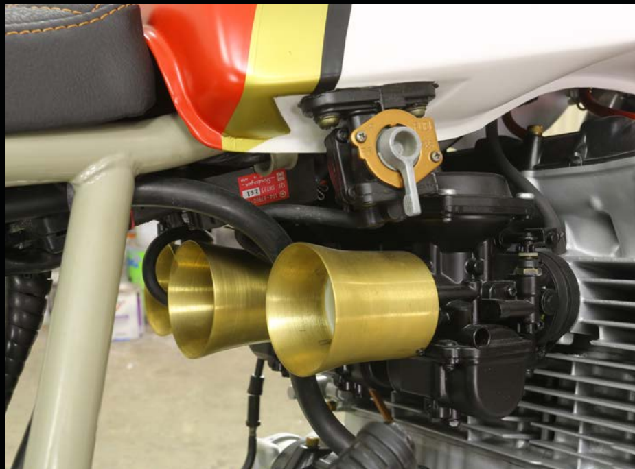
Soustružené mosazné difuzory karburace jsou nákladný detail, svůj účel ale plní na jedničku.
